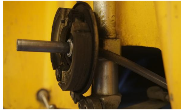
Wassereinleitung in Trommelbremse
